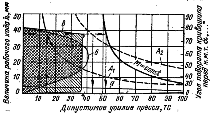
Рис. 288. Сравнение двух прессов номинальным усилием 100 тс, но различной работоспособности
